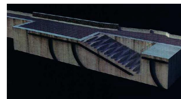
Figure 62 : Exemple de quai à paliers
